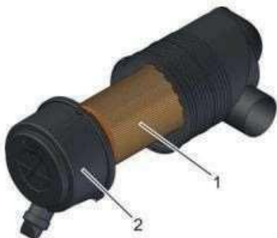
Рис. 37: Разборка корпуса воздушного фильтра
