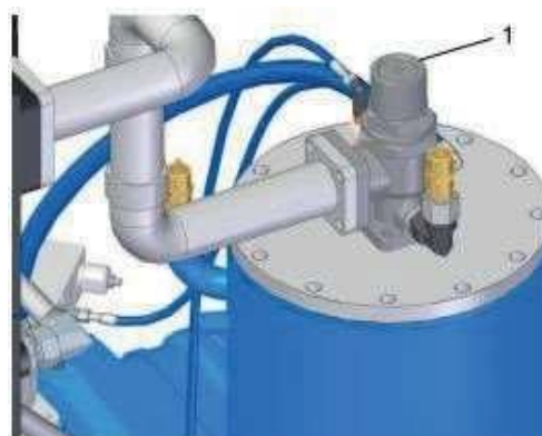
Рис. 10: Клапан минимального давления с функцией обратного клапана
