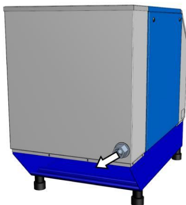
Рис. 20: Подключение сжатого воздуха
