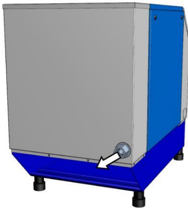
Рис. 20: Подключение сжатого воздуха
