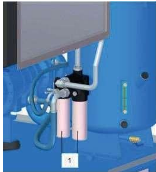
Рис. 12: Масляный фильтр очистки масла
